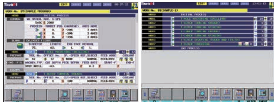
【全工序展开显示】可显示并确认全工序的加工数据。
